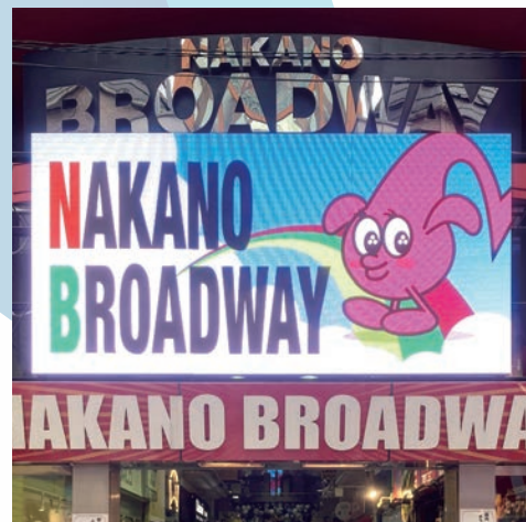
6台連結(横3台×縦2台)
